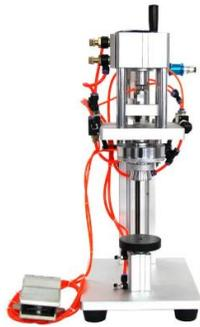
La máquina de prensado nos va ayudar para la actividad de sellado del vino, esta máquina nos ayudará a que no se presenten fugas de air en la botella ya que esto haría que el vino siga con su proceso de fermentación.
