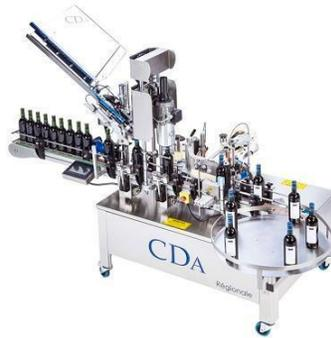
La etiquetadora de botellas brinda un mecanismo de sujeción para mantenerlas en su lugar, un sistema de etiquetado que puede ser adhesivo o por calor, cabezales aplicadores de etiquetas para la aplicación física, un sistema de control para coordinar el proceso, un sistema de ajuste para adaptarse a diferentes tamaños y formas de botellas, dispositivos de detección para garantizar la precisión y dispositivos de seguridad para proteger a los operadores.
