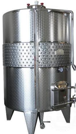
El tanque de fermentación para vinos es un recipiente diseñado para fermentar mosto de uva y convertirlo en vino. Está hecho típicamente de acero inoxidable, con válvulas y conexiones para
