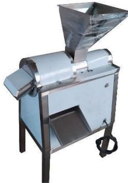
La despulpadora de frutas es una máquina que separa la pulpa de la fruta de otras partes no deseadas. Sus partes incluyen una tolva de alimentación para cargar las frutas, un sistema de corte/triturado para descomponerlas, un tamiz o filtro para separar la pulpa, un sistema de extracción para obtener la pulpa, una tolva de descarga, un sistema de control y dispositivos de seguridad. Estas partes trabajan en conjunto para procesar las frutas de manera eficiente y segura.
