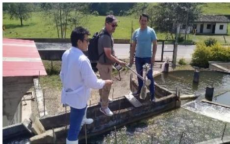
**Figura N°7.** Se repetirán los pasos 5 y 6, con ayuda del molinete para las distintas profundidades del canal A en los puntos de referencia A y B.
