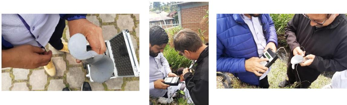
**Figura N°3.** Se reconoce los componentes de los equipos, se verifica y se calibra los molinetes antes de ser usados en la práctica.
