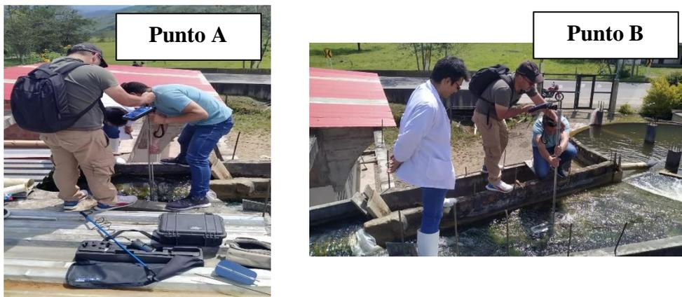
**Figura N°5.** Se monta y se ubica el molinete de cazoletas, para empezar a realizar las mediciones en el punto A y B del puesto de trabajo N°1
