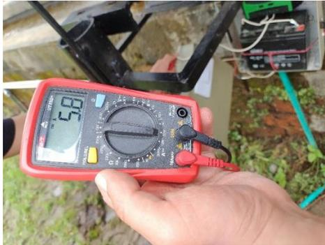
Nota: Proceso de medición de corriente en el sistema hidroeléctrico.
