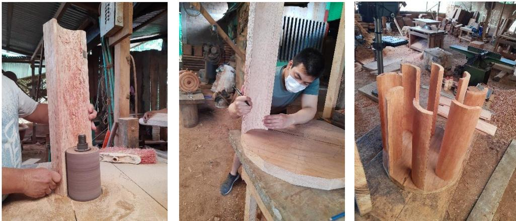
*Nota:* Continuando con el proceso de fabricación de la turbina se elabora y se da forma a los álabes que son parte de la turbina.
