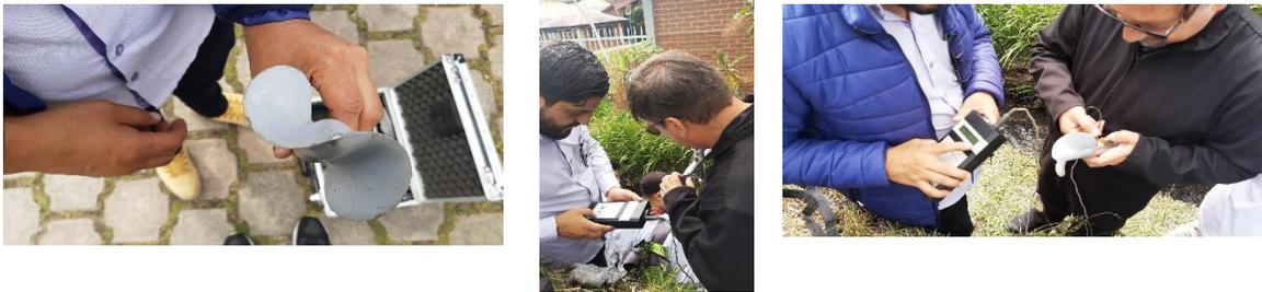
**Figura N°3.** Se reconoce los componentes de los equipos, se verifica y se calibra los molinetes antes de ser usados en la práctica. (Jairo Fajardo (Asesor) y Álvaro León (Coasesor))
