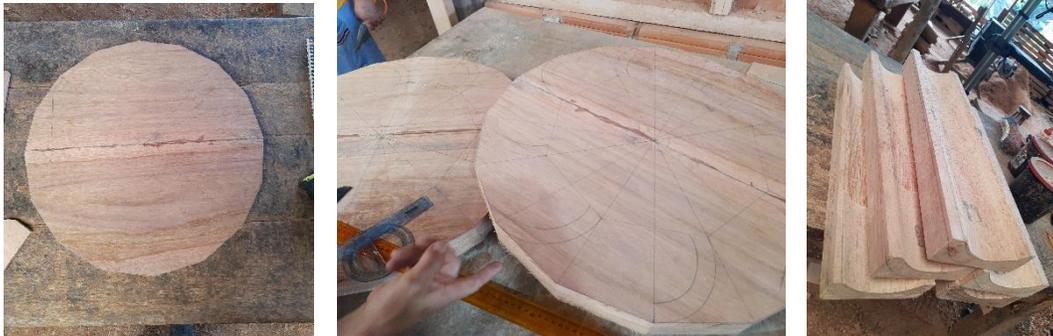
*Nota:* Se ejecuta el proceso de elaboración de la turbina utilizando como materia prima madera fina tratada, teniendo en cuenta el plano en 3D y los cálculos de dimensión.
