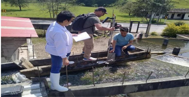
**Figura N°6.** Lectura del caudal por parte del molinete, los datos e información del punto A y B, deberán ser registrados y anexados a una tabla N°1.
