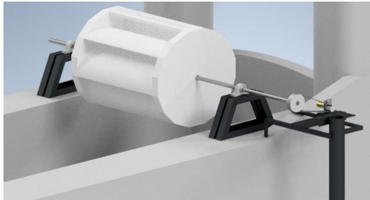
*Nota:* Una vez diseñadas todas las piezas del sistema en 3D se realiza el acoplamiento de cada parte del sistema mecánico del proyecto. De esta manera se visualiza el posicionamiento de la turbina junto con sus soportes.
