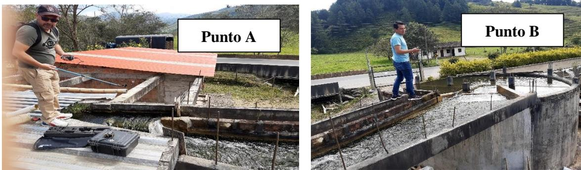
**Figura N°4.** Se procede a realizar las mediciones del caudal, pero antes se escogen los puntos de referencia para medir en distintas profundidades, el caudal del puesto de trabajo N°1.
