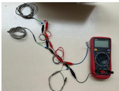
Al momento de medir la corriente fue necesario poner el multímetro en un circuito de amperaje directo es decir el tipo DC que es para tomas de corriente con una respuesta directa, ya que las termocuplas son dispositivos diseñados para medir temperaturas y generar una pequeña tensión (en
