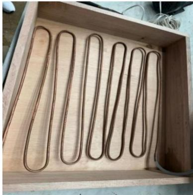
Se llevó a cabo la mezcla asfáltica en capas. Primero, se compactó la primera capa y se colocó un serpentín de cobre para que se adhiriera al asfalto (ver figura 11). Al día siguiente, tras el secado de la primera capa, se aplicó una segunda capa de asfalto sobre la primera y el serpentín de cobre (ver figura 12). Esta segunda capa también fue compactada y se dejó secar durante un día. Posteriormente, realizar sus pruebas.
