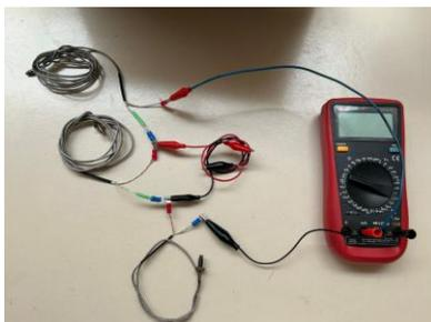
A medida que la muestra de asfalto se calienta, las termocuplas empiezan a registrar la temperatura local en cada punto donde se encuentran ubicadas. La tensión generada por cada termocupla se mide en milivoltios (mV) y es proporcional al aumento de temperatura. Por ejemplo, en un ensayo, se registraron tensiones que varían entre 3,4 mV y 4,3 mV, lo cual corresponde, aproximadamente, a un rango de temperaturas entre 60°C y 90°C.
