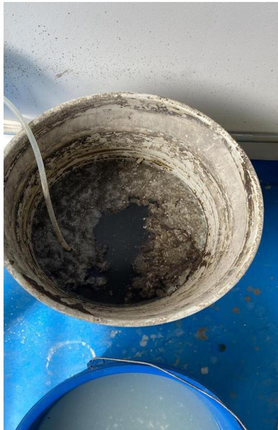
Con el propósito de que los lodos no adquirieran demasiada oxigenación durante el proceso de aclimatación se alimentó como se muestra en la Tabla 8. Se establecieron los días de alimentación y la cantidad de agua residual sintética a aplicar.
