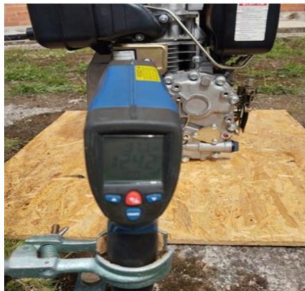
El último paso llevado a cabo para concluir la medición de temperatura en el motor implicó el uso de un sensor específico: un Sensor de temperatura RTD Pt100 (3 hilos). Este tipo de sensor termopar está configurado con tres hilos, dos para alimentación y uno para la transmisión de datos, este tiene la capacidad de medir temperaturas en un rango desde -100°C hasta 400°C. La elección
