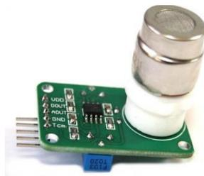
Nota: La figura indica el sensor de CO<sup>2</sup> usado en el proyecto. Fuente: Arduobot Robótica.
