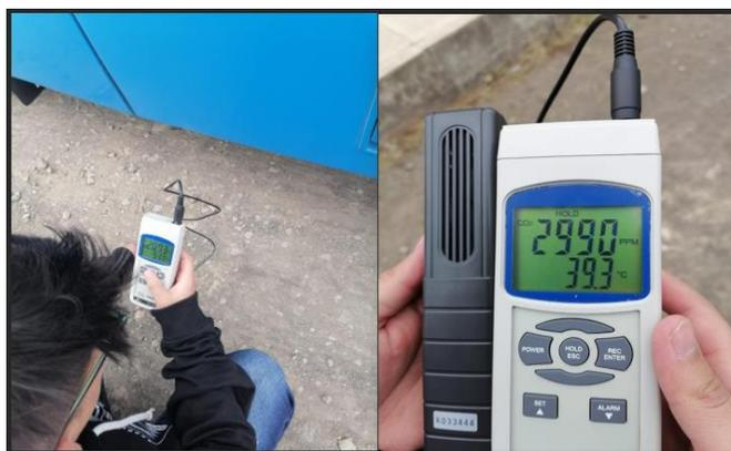
Estos datos fueron tomados para la verificación de la calibración de este dispositivo.
