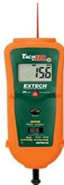
Nota: La figura indica el equipo de medición de RPM. Fuente: DCL metrología.
