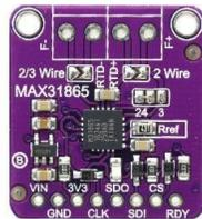
Nota: La figura indica el módulo de temperatura usado en el proyecto. Fuente: Electronilab.
