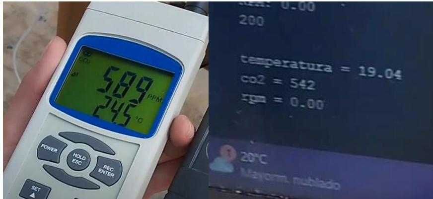
Se realizó la medición con el dispositivo de comparación de datos. El resultado confirma la precisión de los datos de los sensores y la exactitud del registro en la base de datos. También revela la calibración casi exacta del sensor ya que se puede observar que el margen de error es de 47 ppm.
