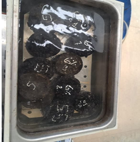
Ilustración 6. Falla de los especímenes.
