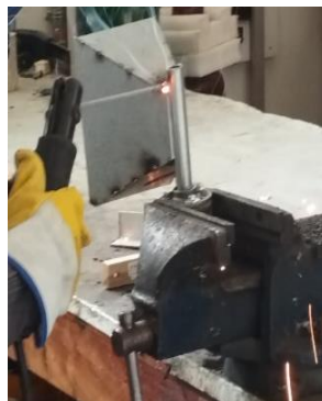
Figura 13. Elaboración de la extrusora parte de la tolva y cañón
