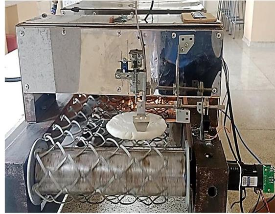
Se desarrolló un prototipo completo de banda transportadora con un sistema de medición de temperatura, esta banda transportadora fue diseñada para optimizar el transporte y el control durante el proceso de horneado de productos. Esta solución combina la eficiencia en el transporte con la capacidad de controlar la temperatura interna durante el horneado.
