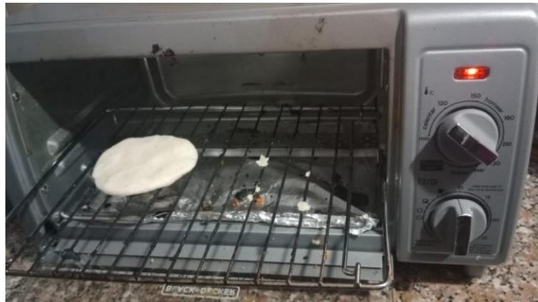
En la Tabla 14, se puede observar diferentes pruebas realizadas con horno eléctrico, en un rango de 230°, las arepas tipo delgada tienen menor temperatura, mientras que el producto tipo grueso tiene mayor rango de temperatura. Para realizar la prueba interna se procedió a tomar la temperatura con el termopar del multímetro, para posteriormente, hallar la relación de esta temperatura con el prototipo final.
