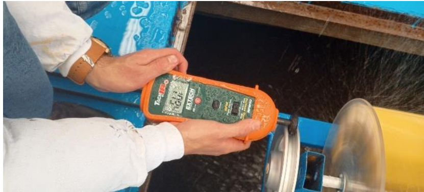
Medición de RPM de la turbina
