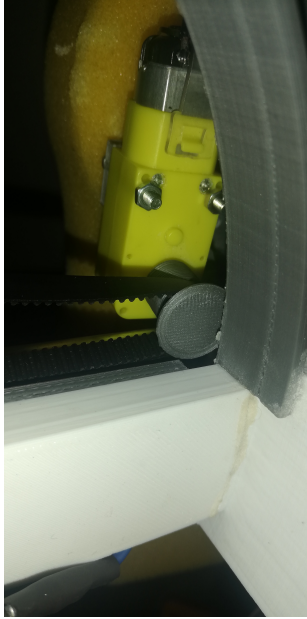
Fig. 17. Puller con tope final para evitar descarrilamiento de banda
