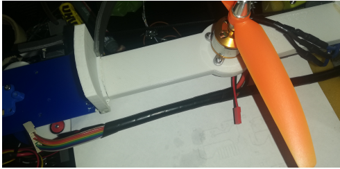
Fig. 16. Enrutado de cableado por medio de espiras plásticas
