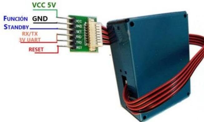
*Nota:* Plantower PMS5003 analizador de MP inferior a 10 micrómetros y su respectiva conexión.
