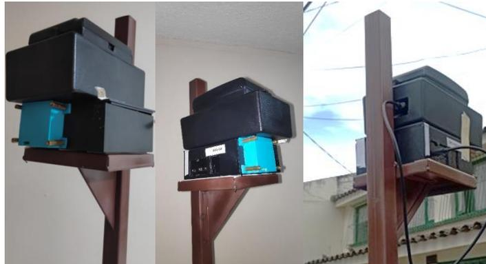
*Nota:* Se evidencia el uso del criterio de instalación mencionado por los manuales de operación e instalación de los sistemas de vigilancia de calidad del aire para la obtención de muestras representativas.
