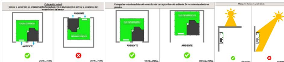
*Nota:* El montaje adecuado del prototipo del sensor SPS30 requiere seguir las siguientes recomendaciones: a. Instalar el sensor de forma vertical. b. Proporcionar aperturas grandes para una adecuada exposición directa al medio ambiente. c. Evitar exposición directa de la luz solar sobre el sensor. Estas directrices se basan en la ficha técnica del sensor y son fundamentales para asegurar un funcionamiento óptimo y mediciones precisas del dispositivo. Fuente: Ficha técnica.
