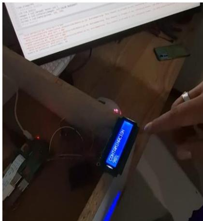
En esta primera prueba se realizó una contaminación directa en las manos para observar el comportamiento del código que se implementó, en este caso se obtuvo un resultado coherente conforme al nivel de suciedad tenida en las manos.
