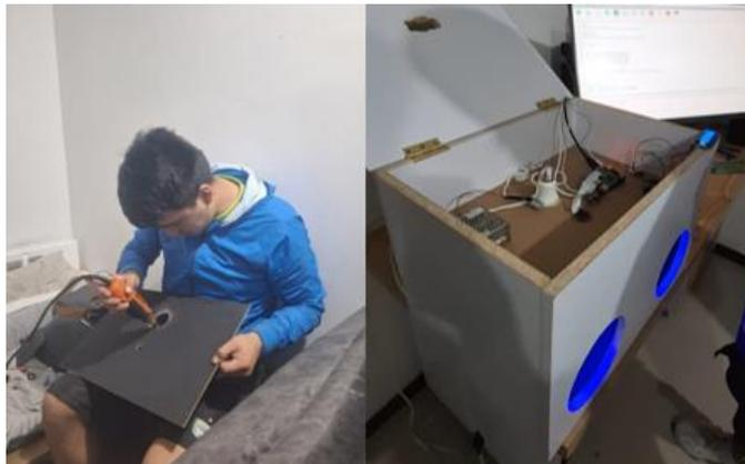
Se realizaron varias pruebas con el fin de verificar el correcto funcionamiento del prototipo, las pruebas consistían en hacer muestras con diferentes niveles de contaminación, para que el dispositivo mediante el procesamiento de imágenes logre determinar la cantidad de microorganismos existentes en las manos.
