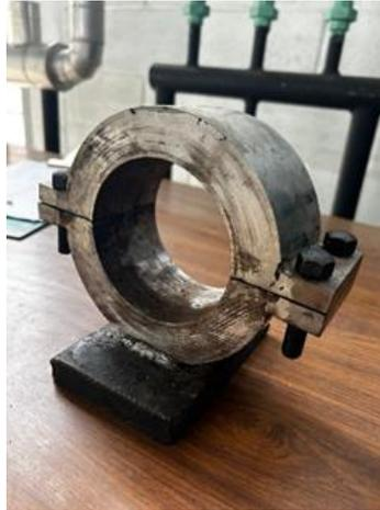
El funcionamiento del equipo consistió en la aplicación de una carga tangencial sobre la unión o interfaz entre las capas a una velocidad constante de (50 mm/min). El resultado es la carga máxima de resistencia.
