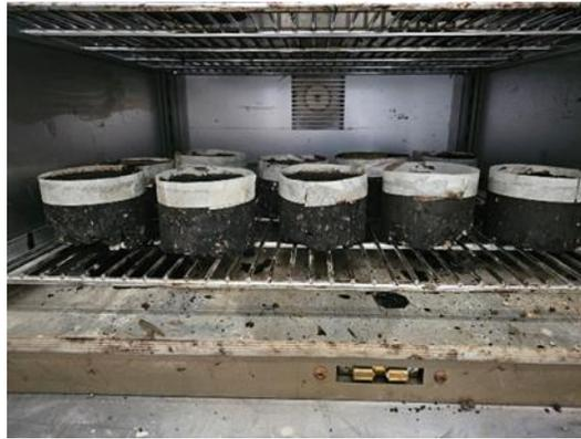
Para aplicar la segunda capa se utilizaron los moldes para evaluar la resistencia a la compresión simple de mezclas asfálticas. Este molde tiene forma cilíndrica con el mismo diámetro. Este molde permitió formar la primera capa de la muestra, que ya contenía el asfalto residual de la emulsión, y compactar sobre ella una segunda capa de mezcla asfáltica de 5 cm de espesor. Dado que esta capa sólo se compacta, por un lado, se realizaron 100 golpes para asegurar una adecuada compactación.
