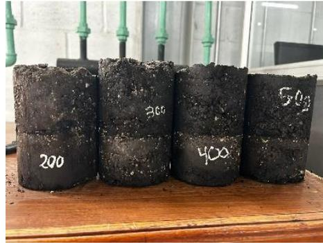
Después del enfriamiento del conjunto bicapa de mezcla asfáltica adherida con emulsión preparado de esta forma, se obtuvo el espécimen de prueba para el estudio de la adherencia.
