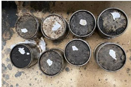
Una vez realizados estos especímenes se procedió a realizar, a estos, el ensayo de gravedad específica bulk e igualmente se realizó el ensayo de gravedad específica máxima teórica de la muestra. Una vez realizados estos 2 ensayos, aparte de también haber realizado los ensayos de gravedad específica para los agregados a utilizar, así como también para el asfalto, se obtuvo los siguientes resultados.
