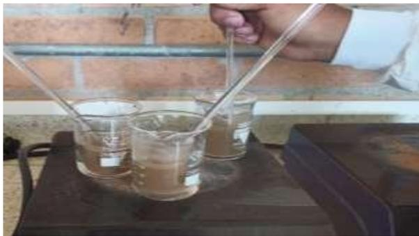
A medida que la mezcla gelificaba, se añadieron 6 y 8 ml de glicerina (según tipo de preparación) seguidos de 5 ml de ácido acético. La agitación continuó suavemente durante un período de 20 minutos, resultando en una mezcla uniforme y coherente. Esta mezcla se transfirió a papel aluminio con el propósito de someterla a un proceso de secado en una estufa de convección forzada.
