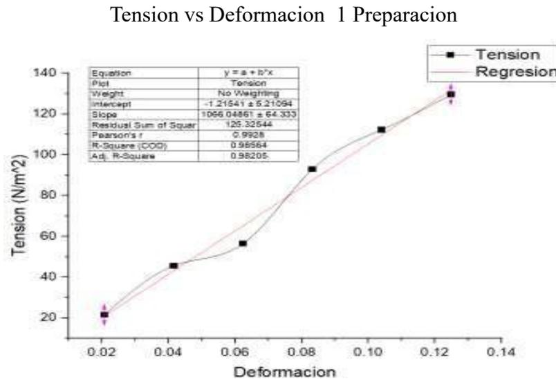
Según los datos presentados en la figura 28, la pendiente sugiere una relación lineal positiva entre la tensión y la deformación. Se observa que, por cada incremento unitario en la deformación, la tensión aumenta en promedio en 356.28 unidades. En el punto de intersección, donde la
