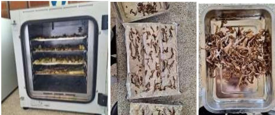
**2.1.3.7. Molienda.** Una vez secadas las muestras se retiran de las bandejas y se trituran y muelen en moteros hasta ser pulverizados, para después ser tamizados a través de una malla N° 60 aproximadamente 0,0063 mm.(figura 10).
