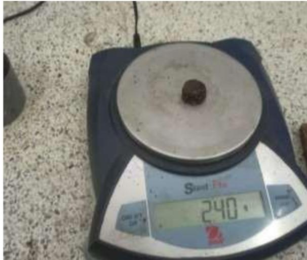
Los pellets obtenidos tras la compresión fueron secados en horno a temperaturas de 90 y 100 °C. Este proceso permitió eliminar eficazmente la humedad sin comprometer la integridad del bioplástico. Además, contribuyó a consolidar la estructura de los pellets, lo que indica un proceso exitoso y una mayor estabilidad estructural del producto final. Esto lo convierte en un material más adecuado para llevar a cabo pruebas mecánicas.
