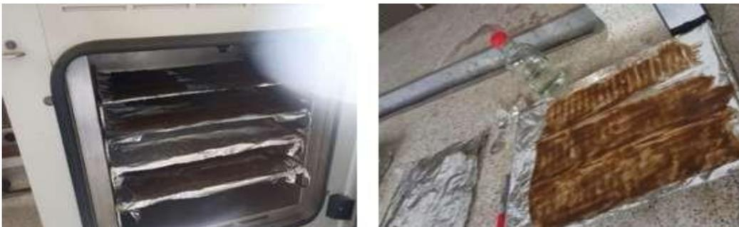
Después de la gelificación del bioplástico, se procede a su transferencia a cajas Petri, las cuales son transportadas a una estufa para someterse a un proceso de secado a una temperatura constante de 60, 70 y 80°C (según tipo de preparación) durante un período de 12 horas (figura 12). Al finalizar esta etapa, el papel aluminio es retirado de la estufa, resultando en la obtención satisfactoria del bioplástico, el cual posteriormente es extraído de dicho papel (figura 13).
