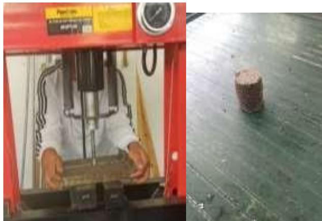
En la figura 19, se puede observar el procedimiento de prensado mediante una maquina prensadora,destacando el producto final que consiste en la formación de pellets. Estos pellets se destinan específicamente para llevar a cabo pruebas que permitirán evaluar las pruebas mecánicas.
