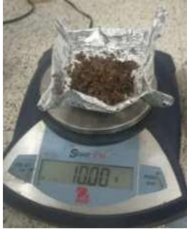
Los 10 gramos de bioplástico pesado es colocado en el molde creado para así someterlo a una máquina de prensado con el fin de obtener pellets más firmes.
