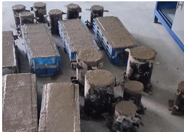
Luego de 24 horas de la elaboración de las probetas, se llevó a cabo el desencofrado y curado respectivamente. Cabe resaltar que todas las probetas se sometieron a las mismas condiciones durante estos procesos Figura 11.
