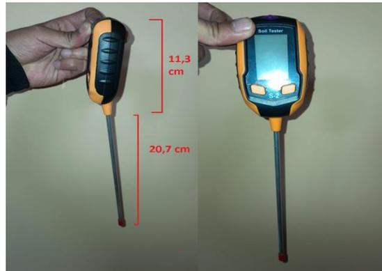
Nota: En esta imagen se observa las medidas del Tester de humedad S-2
