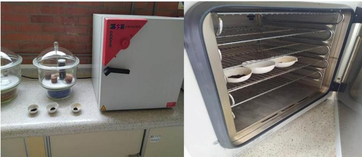
Nota: En la figura se muestra el uso de los hornos para realizar el secado de la muestra
