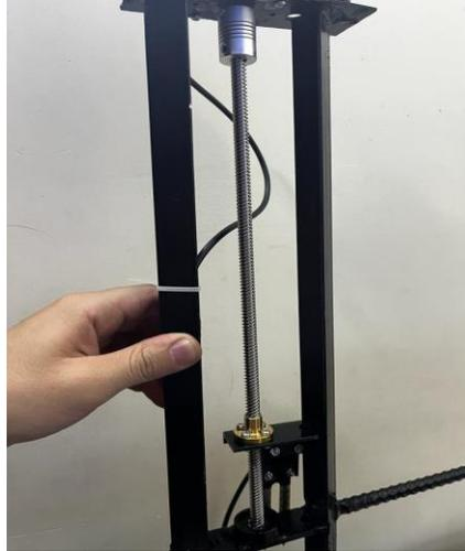
Nota: La figura muestra el mecanismo de desplazamiento para el sensor de humedad.
