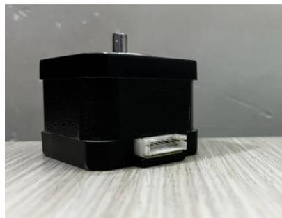
Nota: La figura muestra el motor paso a paso Nema 17 que se usara en el mecanismo.
