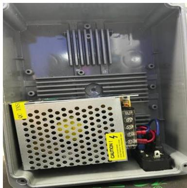
Nota: La figura muestra la fuente de alimentación dentro de la caja de proyecto con su respectivo socket.
