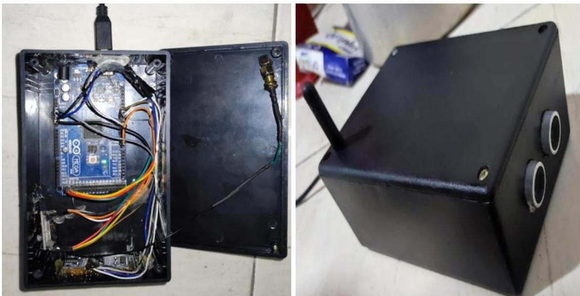
La instalación del sensor de nivel en el tanque de abastecimiento se posicionó estratégicamente en una sección del tanque, de manera que monitoree continuamente el nivel de agua. Esta ubicación garantiza una medición precisa lo que resulta fundamental para prevenir el desbordamiento y mantener un control óptimo de los recursos hídricos.
