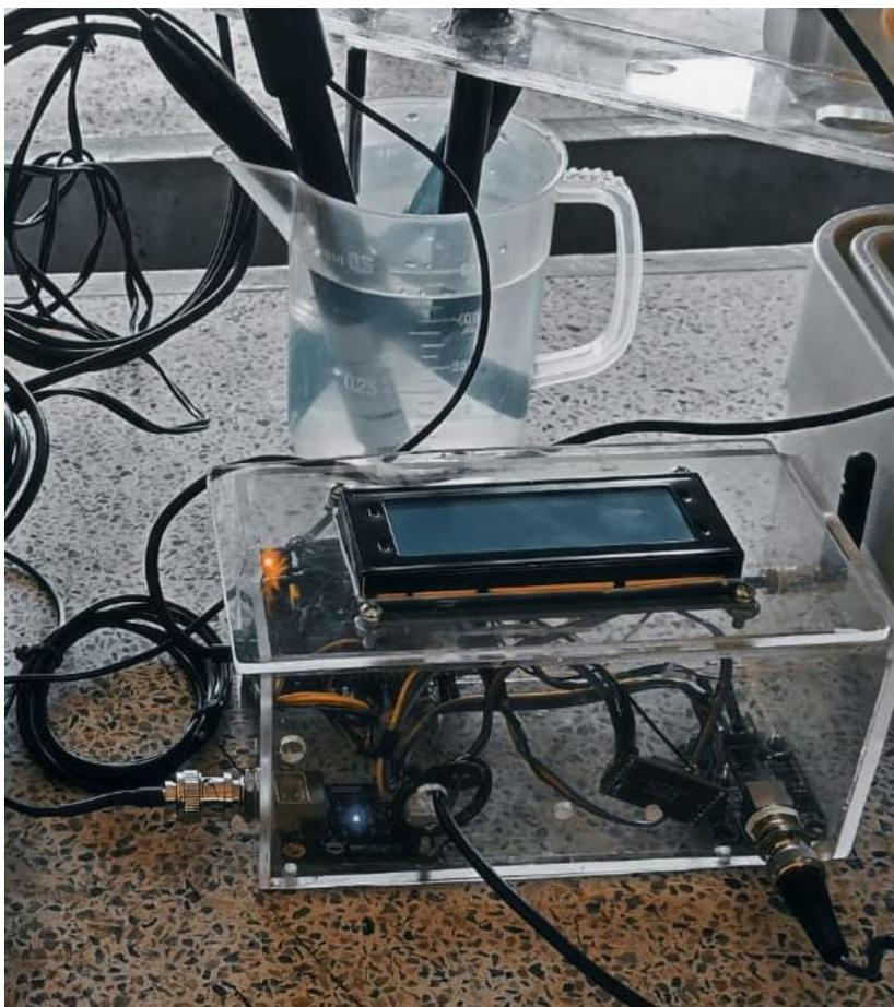
En las fotografías adjuntas se puede evidenciar el proceso de instalación de la unidad de monitoreo de variables que incluye una cuidadosa disposición de los sensores especializados para la medición de temperatura, oxígeno disuelto, pH y turbidez en las instalaciones de la microempresa Acuímayo por ello estos sensores han sido estratégicamente ubicados en el estanque de cría de truchas garantizando una cobertura efectiva de las condiciones del agua.
