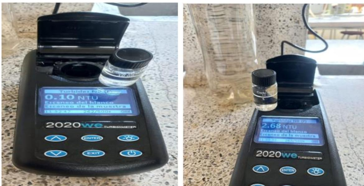
La tabla a continuación presenta una comparación entre las mediciones de turbidez obtenidas mediante el uso del turbidímetro, considerado como el estándar de referencia del sensor de turbidez. Cada conjunto de datos representa mediciones tomadas en condiciones similares, permitiendo una evaluación precisa de la capacidad del sensor para proporcionar lecturas consistentes y confiables en comparación con el equipo de referencia.
