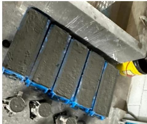
Una vez terminado este proceso, se deja reposar por 24 horas, para luego desmoldar las vigas y proceder a humedecer en tanque ubicado en laboratorio durante 28 días para que estas obtengan la resistencia diseñada anteriormente, una vez alcanzada la resistencia máxima del concreto se las retira del agua y se procede a fallarlos.
