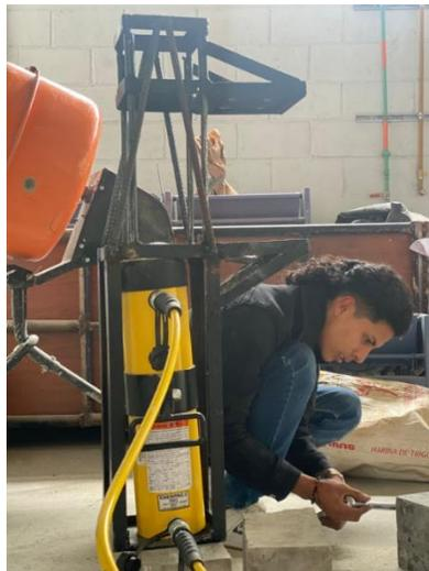
La utilización de esta estructura es la siguiente: en primer lugar, se introducen los torones en la viga con la configuración (ver figura 21) para llevar a cabo el proceso de postensado, y se aseguran
