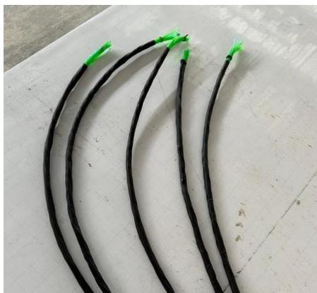
Con la obtención de los productos esperados (torones de nylon de capa simple de diámetro 125 mm formado con hilos de 3,3 mm) se procede a la obtención de resultados de tracción del mismo,
