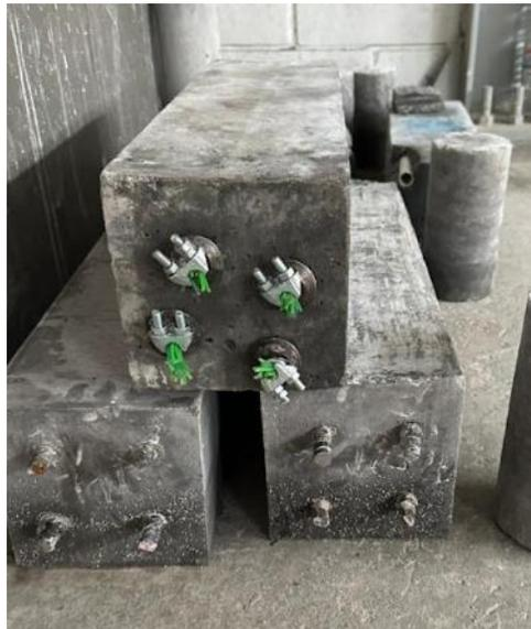
La viga se coloca en la estructura con el propósito de tensionar los torones uno a uno en una configuración cruzada. Esta metodología es crucial para evitar que la viga esté sometida a un mayor esfuerzo en un solo eje. El esfuerzo de tensión aplicado en cada torón fue de 619 KPa (100 psi), que corresponde a la falla del primer hilo del torón.
