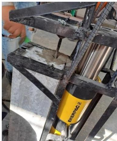
Luego de tensionar el torón, se lo asegura en el extremo faltante y se lo lleva al proceso de curado por 28 días.
