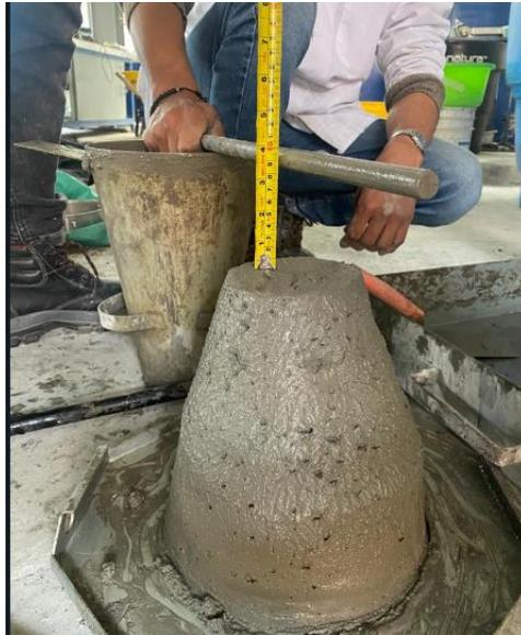
Después de llevar a cabo el ensayo para determinar la fluidez de la mezcla, se procede a insertar las varillas en los orificios previamente realizados en las tapas. Luego, se lubrican los moldes y se vierte la mezcla de concreto tanto en las formaletas de las vigas postensadas y las convencionales
