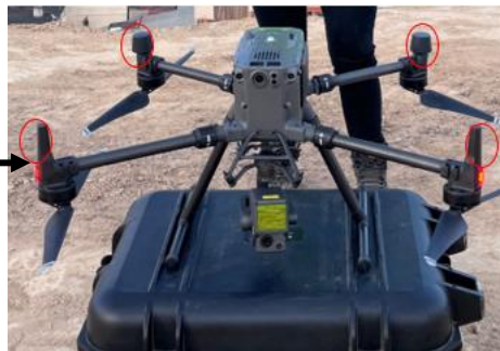
Antenas de conexión entre dron y D-RTK2
